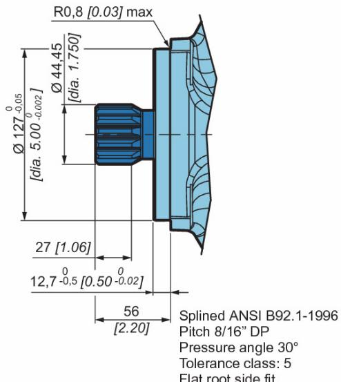
**6** 14 teeth; Shaft torque: 600 Nm [5 310 in.lbf]
