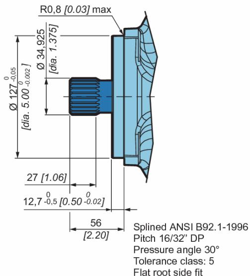
**3** 23 teeth; Shaft torque: 1000 Nm [8 851 in.lbf]
