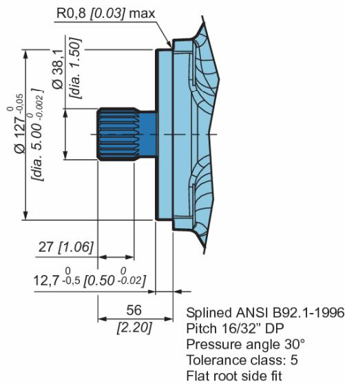
**5** 13 teeth; Shaft torque: 1500 Nm [13 276 in.lbf]
