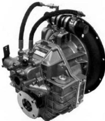
Boite de vitesses ZF équipée d'un réfrigérateur d'huile de type Bowman standard DC.
