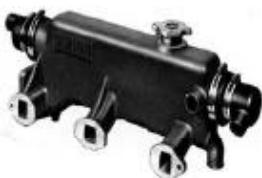
BL180-3318 Echangeur de chaleur, nourrice et collecteur d'échappement refroidi par eau combinés pour les moteurs diesel British Leyland à 4 cylindres de 1,5 et 1,8 litres.
